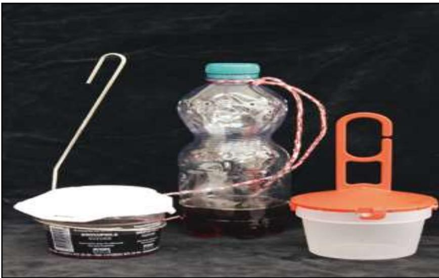
**Figure 7** : De gauche à droite : pièges RIGA, pièges de fabrication propre en PET et pièges Profatec pour la surveillance et les captures en masse. (Stefan K *et al.* , 2017).
